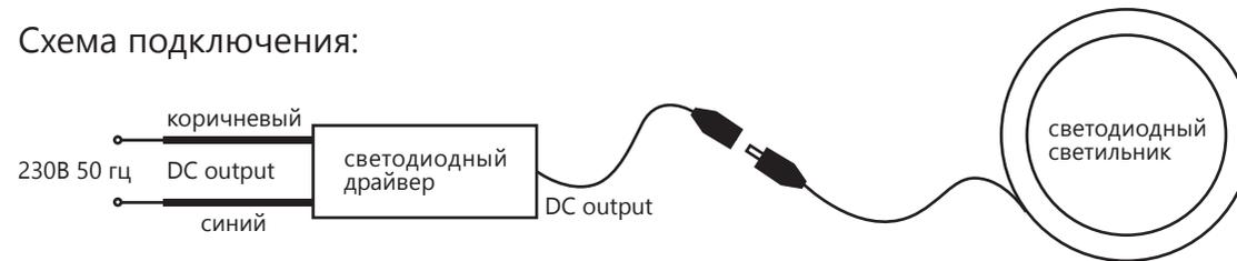
Диммируемый драйвер DM500 ТМ Feron предназначен для подключения к сети 230В/50Гц, светодиодных светильников ТМ Feron (9 - 24Вт)\*. Позволяет менять яркость источника света при помощи стандартного светорегулятора для ламп накаливания и галогенных ламп (TRIAC диммеры, реостатный диммер).
